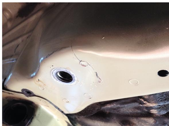
Die 4 Stellen der Hinterachsaufnahme der Karosserie mit dem Winkelschleifer blankschleifen damit eine gute Schweißverbindung entstehen kann.
